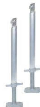
Tukijalat pari #6050-25-35 cm, 40-55 cm, 60-90 cm. Tuki-jalkapari yli 2,75 cm rampille. Pidempiin ramppeihin tukijalka 1,8 metrin välein.
