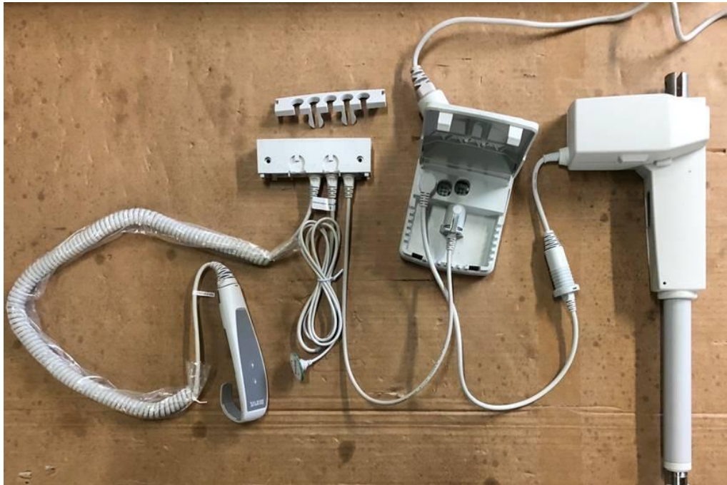
Kaapelikaavio, jossa on molemmat hallintalaitteet
