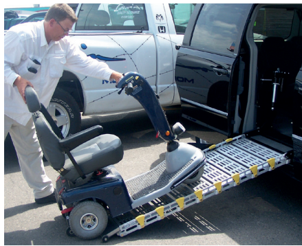
Rullaramppi autoon. Rampin voi kiinnittää autoon käsi käyttöisenä tai sähköisesti toimivana. Samaa ramppia on mahdollista käyttää myös siirrettävänä ramppina.
